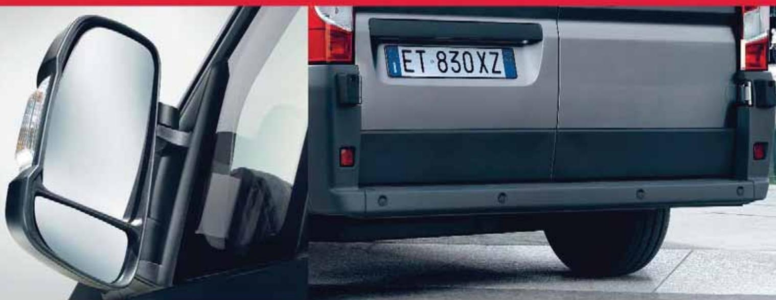
**Регулируемые поворотные зеркала с электроприводом.** Зеркала заднего вида с двумя параболическими отражающими поверхностями нового Ducato гарантируют панорамный обзор пространства за автомобилем и максимальную практичность в использовании за счет того, что их регулировка и складывание осуществляется с помощью электроприводов из кабины. Обе параболические поверхности регулируются независимо друг от друга.
