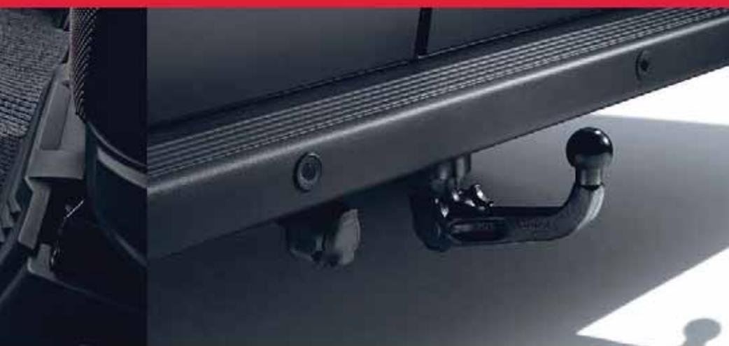
Извлекаемое прицепное устройство
