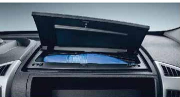
В приборной панели есть холодильный отсек, в котором можно охладить еду и напитки, при включенном кондиционере, работающем в режиме охлаждения.
