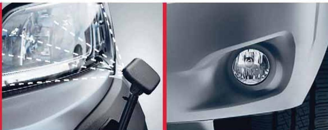
**Передние противотуманные фары,** устанавливаемые в нижней части переднего бампера, обеспечивают максимальную видимость, вне зависимости от погоды.
